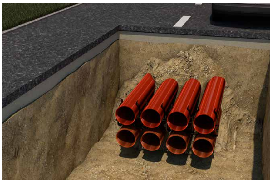
Minimale Verlegetiefe von Kabelschutzschläuchen bei Schwerlastverkehr SLW60
